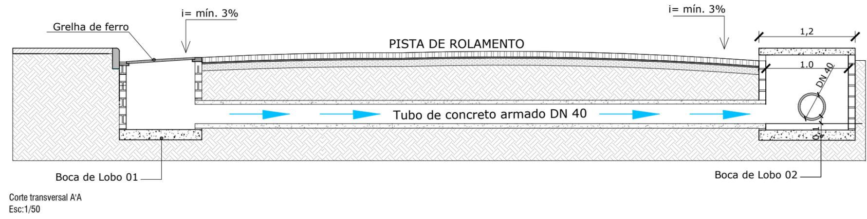
A boca de lobo 02 será ligada a uma boca de lobo existente através de tubo de concreto armado DN 40. Por se tratar de uma rua consolidada, para não quebrar as calçadas existentes, os canos serão instalados pela extremidade da via.
